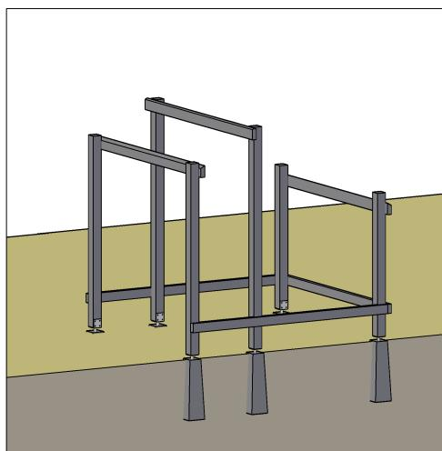
Der Unterstand/Schuppen muss verankert werden, zum Bsp. auf einem Fundament, mit Pfostenträger oder mit Pfostenschuhen.
